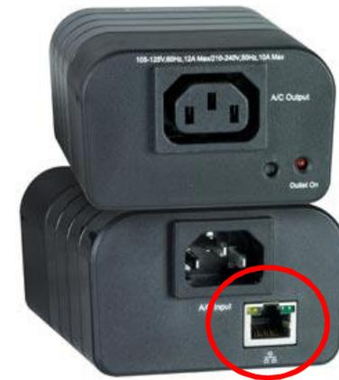
Control de la alimentación eléctrica: ON/OFF/REBOOT de equipos de forma segura a través de la red IP, ideal para cajeros automáticos, equipos de comunicaciones, Modems, firewalls, cámaras IP u otros dispositivos.
